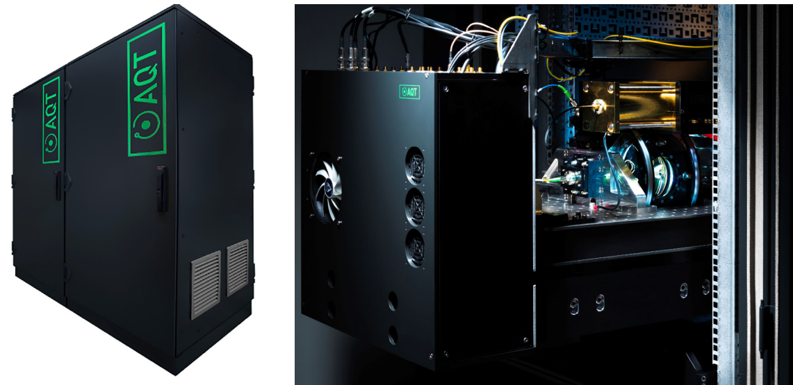
Abb. 2: Links ein Ionenfallen-Computer von AQT. Ionenfallen Quantenprozessor in einem 19" Rack (rechts).
